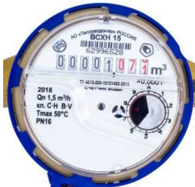
Рисунок 1. Счётный механизм счётчика BCXH-15
